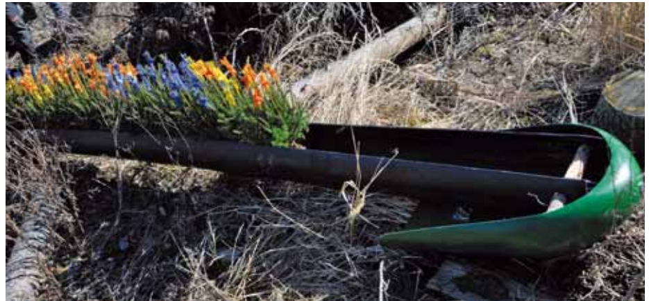
Das Transportsystem - Holzrückepfanne und Log Line mit einer Kleinseilwinde - für Forst-Containerpflanzen führt TS-Holz auf der Austroma vor. Foto: TS-Holz
