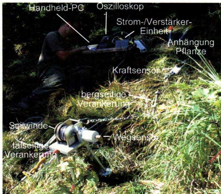
Abbildung 1: Versuchsaufbau Wurzelszugversuch
